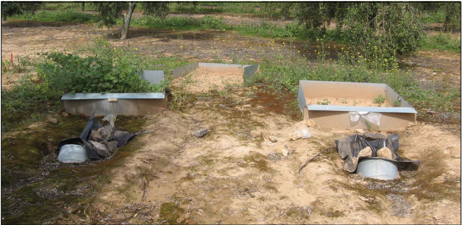
Figura 3. Bloque de microparcels y dispositivos colectores
